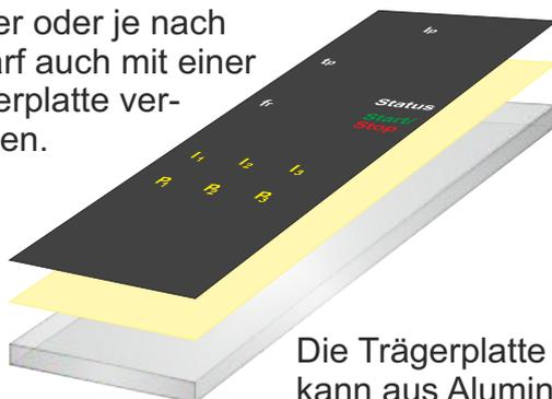
Die Trägerplatte kann aus Aluminium oder aus Kunststoff sein.
